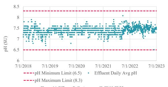
Figure 14. Effluent Daily Average pH, FY19-FY23
